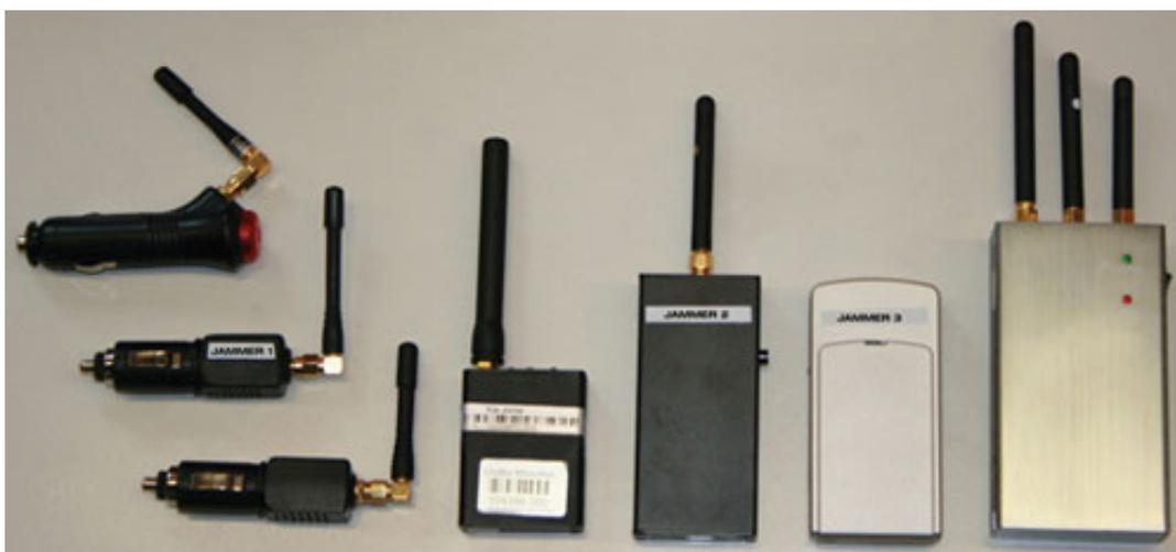
Глушение GSM практически бесполезно, так как терминал копит сообщения в своей памяти и, после восстановления сигнала, передаёт всё на сервер. При этом диспетчер сможет выявить, пусть и с задержкой, махинации водителя. Ситуация с глушением GSM/GPS/ГЛОНАСС куда серьезнее, ведь терминал не может формировать сообщения о своём перемещении без этих сигналов и часть трека пропадает безвозвратно. Признаком таких махинаций могут быть систематические разрывы в смены одного и того же водителя.
